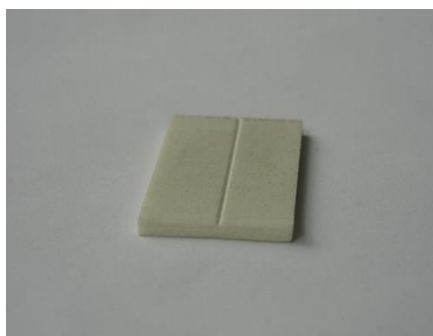
Figura 40: Placa de Fibra de Vidro utilizada como Suporte.
